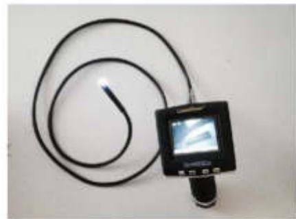
Endoscope numérique pour rechercher des gîtes dans les arbres
