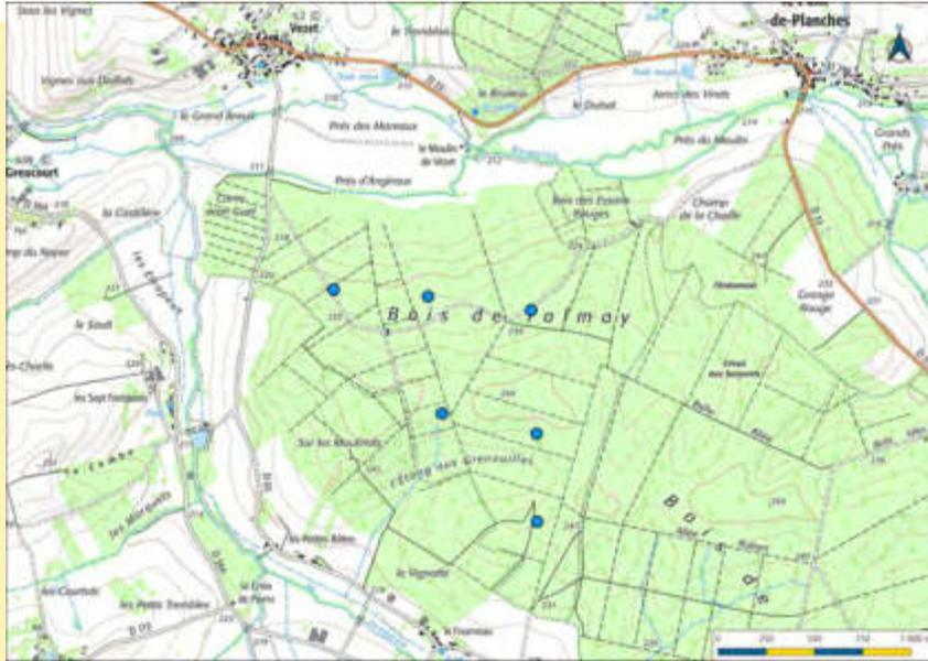
Ci-dessus, vous pouvez voir l'implantation (points bleus) qui a été retenue à l'issue des études pour le projet de La Romaine. Le projet comporte 6 éoliennes de 230 m de hauteur en bout de pale pour une puissance totale de 33,6 MW rendue possible par les récentes avancées technologiques et permettant d'utiliser au mieux la ressource en vent. Ce projet permettra **d'alimenter (chauffage compris) environ 25 000 personnes.**
