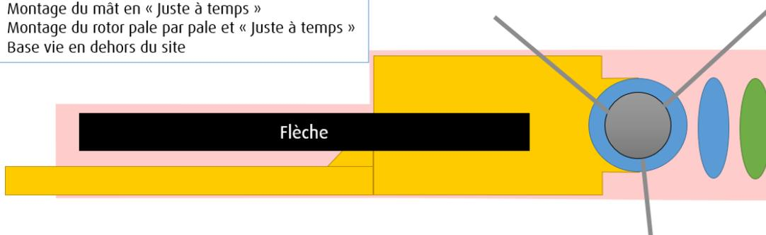
La partie représentée en rouge correspond à un défrichage type optimisé pour la phase de construction dans lequel nous avons limité le stockage sur site au strict minimum avec une flèche située dans l'axe de la plateforme et dans le prolongement du chemin. Cette configuration a été celle qu'ENERTRAG a privilégiée pour concevoir son implantation finale.
